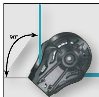
Pour un angle de 90°: le coefficient de charge est de 140 %. Une charge de 100 kg sur le cordage représente une charge de 140 kg sur la poulie
