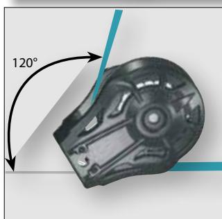
Pour un angle de 120°: le coefficient de charge est de 180 %. Une charge de 100 kg sur le cordage représente une charge de 180 kg sur la poulie
