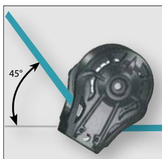
Pour un angle de 45°: le coefficient de charge est de 75 %. Une charge de 100 kg sur le cordage représente une charge de 75 kg sur la poulie
