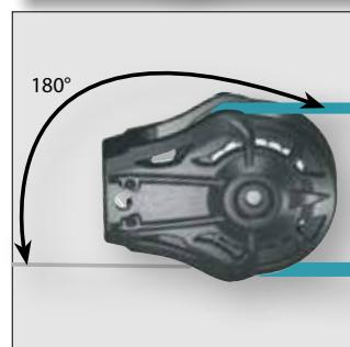
Pour un angle de 180°: le coefficient de charge est de 200 %. Une charge de 100 kg sur le cordage représente une charge de 200 kg sur la poulie
